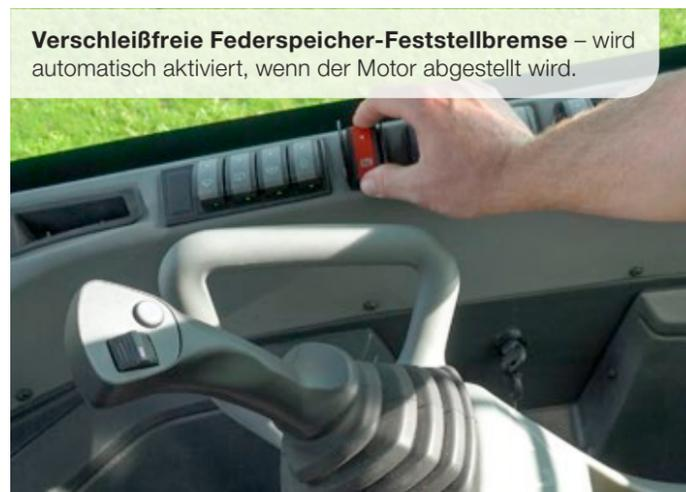
**Verschleißfreie Federspeicher-Feststellbremse** – wird automatisch aktiviert, wenn der Motor abgestellt wird.
