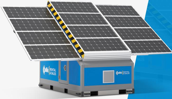
Der Solargenerator ist unsere mobile Energiequelle, bei der die Energie durch Sonnenkollektoren erzeugt wird. Die Energie wird in einer 10-kWh-Batterie gespeichert. Der Generator ist auf einer Plattform aufgebaut, die leicht mit einem Gabelstapler bewegt werden kann. Die Paneele lassen sich einfach und schnell zusammen- und auseinanderfalten.
