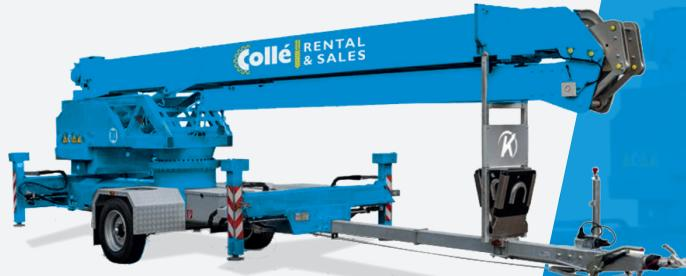
Der K300E beweist, dass Leistung und Langlebigkeit Hand in Hand gehen können. Dank seiner 22-kW-Lithium-Eisenphosphat-Batterie arbeitet dieser Kran rein elektrisch. Er fährt und hebt emissionsfrei leise, sauber und kraftvoll.
