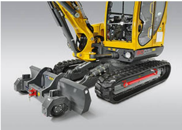
Après le montage d'un châssis à lorries à entraînement hydraulique, la pelle compacte devient la pelle 8003 railway - une pelle rail-route parfaitement adaptée au travail sur les voies ferrées. Pour en apprendre davantage, veuillez cliquer sur « Applications ».
